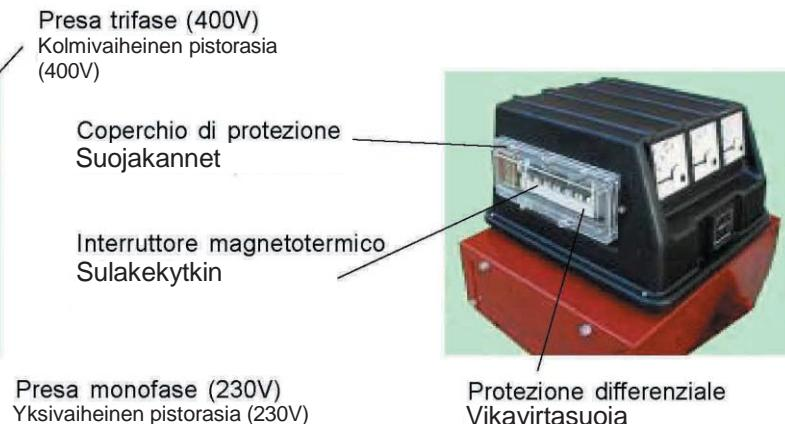
1.6 Per dare tensione alle prese (e ai carichi) sollevare il perchietto dell' interruttore e commutare in posizione ON sia il differenziale che il magnetotermico.
