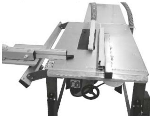
6. Inställning av glidbordsstyrningen: Kullagerstyrning kan ställas in genom att man lossar skruv A. Om bordet är för lättgående, lossa skruv A, flytta kullagret uppåt och dra sedan åt skruven igen. Om bordet är tröggående, lossa skruv A, flytta kullagret nedåt och dra sedan åt skruven igen. Se till att styrskenan alltid är ren.
