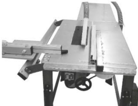
6. Pöytäohjaimen säätö: kuulalaakerinohjaus voidaan säätää irrottamalla ruuvi A. Jos pöytä liikkuu liian kevyesti, irrota ruuvi A, aseta kuulalaakeri ylös ja kiristä jälleen ruuvi. Jos pöytä liikkuu jäykästi, irrota ruuvi A, aseta kuulalaakeri alas ja kiristä jälleen ruuvi. Huolehdi siitä, että ohjainkisko on aina puhdas.
