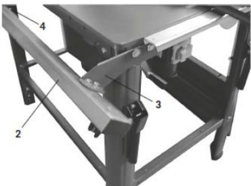
2. Asenna ohjaintanko pöytalevyn vasemmalle puolelle pöydän ja pidikkeen (3) etuosan väliin välilevyn (A) avulla.
