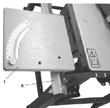
4. Asenna vastekisko pöydän päälle. Ruuva kuusikantaruuvi M 10 (A) ja aluslevy 12 (B) kiinni pöytään vastekiskon ja muovirenkaan (C) läpi. Työnnä kampiruubi M8 (D) yhdessä aluslevyn 8 (E) kanssa vasteputken, muovirenkaan (F) ja segmentin läpi ja kiristää pöydän alapuolelta aluslevyllä 8, jousilevyllä ja vastamutterilla M8 niin, että kun kampea painetaan alas, se jännittyy.
