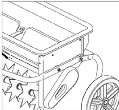
6. Yhdistä vetotangot ja syötön säätöyksikkö M6x65 pulteilla, M6 lukkomuttereilla ja kahdella Ø6 aluslevyllä kuvan mukaisesti. Älä kiristä pultteja ja muttereita vielä. Yhdistä syötön säätöyksikön tanko ja säätölevy toisiinsa Ø8 aluslevyllä ja M8 lukkomutterilla kuvan mukaisesti. Säädä vetotangon, pyörätangon ja säiliön asentoa tarpeen mukaan ja varmista, että säätökahva toimii asianmukaisesti. Kiristä sitten pultit ja mutterit.
