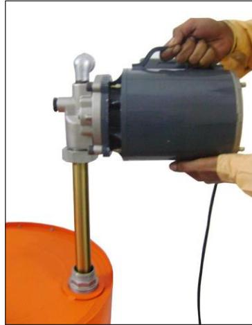
9. Ta cirka 30 ml olja och häll det i pumpens utlopp genom knäröret. Det smörjer kugghulhuset och gör det lättare att lufta pumpen.
