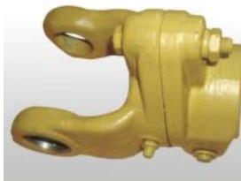
4. **MOMENTBEGRÄNSARE MED FRIKTIONSSKIVOR:** Begränsar kraftöverföringen till inställt värde. Ändra inte vridmomentet på muttrarna, eftersom det ger en ändring på kalibreringen. Spänningen på friktionsskivorna kan justeras genom att öka eller minska höjden på fjädern. Dra åt eller lossa 8 muttrar  $\frac{1}{4}$  varv och kontrollera funktionen. Upprepa vid behov. Om friktionsskivorna är för mycket spända, kan det orsaka skador på arbetsmaskinen, traktorn eller axeln. Smörj inte.
