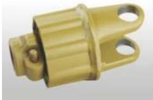
3. **MOMENTBEGRÄNSARE MED BRYTBULT:** Avbryter kraftöverföringen när vridmomentet överskrider inställt värde. Byt ut brytbullen mot en med samma dimensioner och motståndsklass. Smörj en gång under varje användningsperiod och efter förvaringen.
