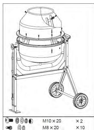
7. Kiinnitä kallistuspyörä kahdella M8 kuusiopultilla, aluslevyllä, lukkoaluslevyllä ja lukkumeritterilla.
