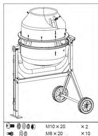
7. Sätt fast ratten med två sexkantsbultar M8, en bricka, en låsbricka och en låsmutter.
