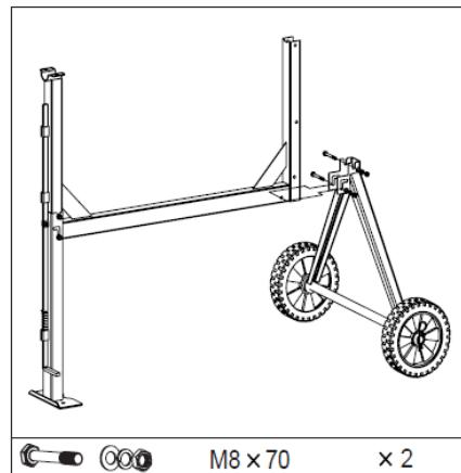
4. Kiinnitä rummun alaosa jalustaan kannatinkiinnikeellä. Kiinnitä kahdella M8x65 kuusiopultilla, kahdella aluslevyllä, kahdella lukkoaluslevyllä ja kahdella M8 mutterilla. Lukitse Ø42 spiraalirenkaalla. Kiinnitä rummun toinen puoli lukkolevyllä ja kahdella M8x20 kuusiopultilla.
