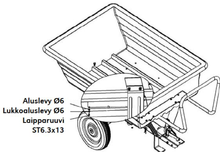
10. Työnnä silmukkasokka aisan ja vetokappaleen läpi ja kiinnitä R-sokalla.
